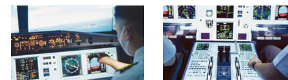
飞行模拟器 1:1 模拟驾驶舱内设有主仪表版、飞行控制组件 (FCU)，以及多用途控制及显示组件 (MCDU)
